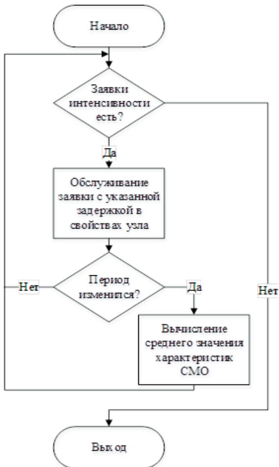
Рис. 3.94. Алгоритм узла «Обработка» одноканальной СМО с отказами
