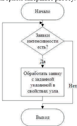
Рис. 3.105. Алгоритм узлов «Обработка», «Обработка2», «Обработка3» многоканальной СМО с ограниченной длиной очереди
