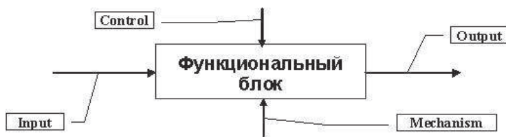
Рис. 3.59. Функциональный блок в нотации IDEF0
